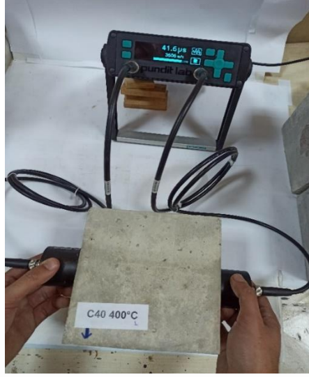
Şekil 6. Upv cihazıyla örnek bir ölçüm deneyi.
