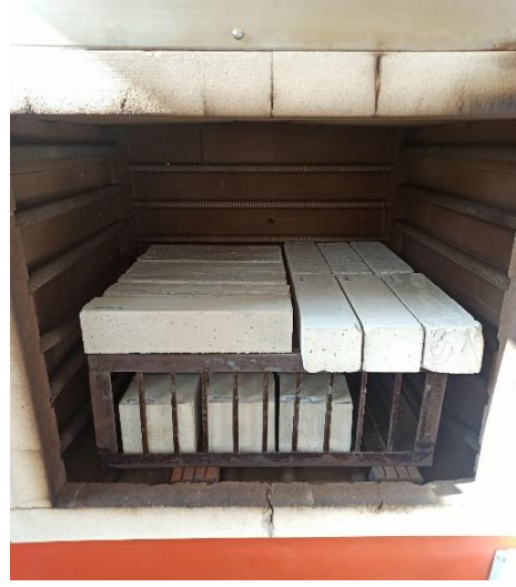
Şekil 4. Numunelere sıcaklık etkilerinin uygulandığı fırın.
