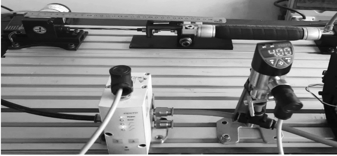
Şekil 1. DMSP-20-200N RM-RM'nin Statik Karakteristik Deneysel Seti.
