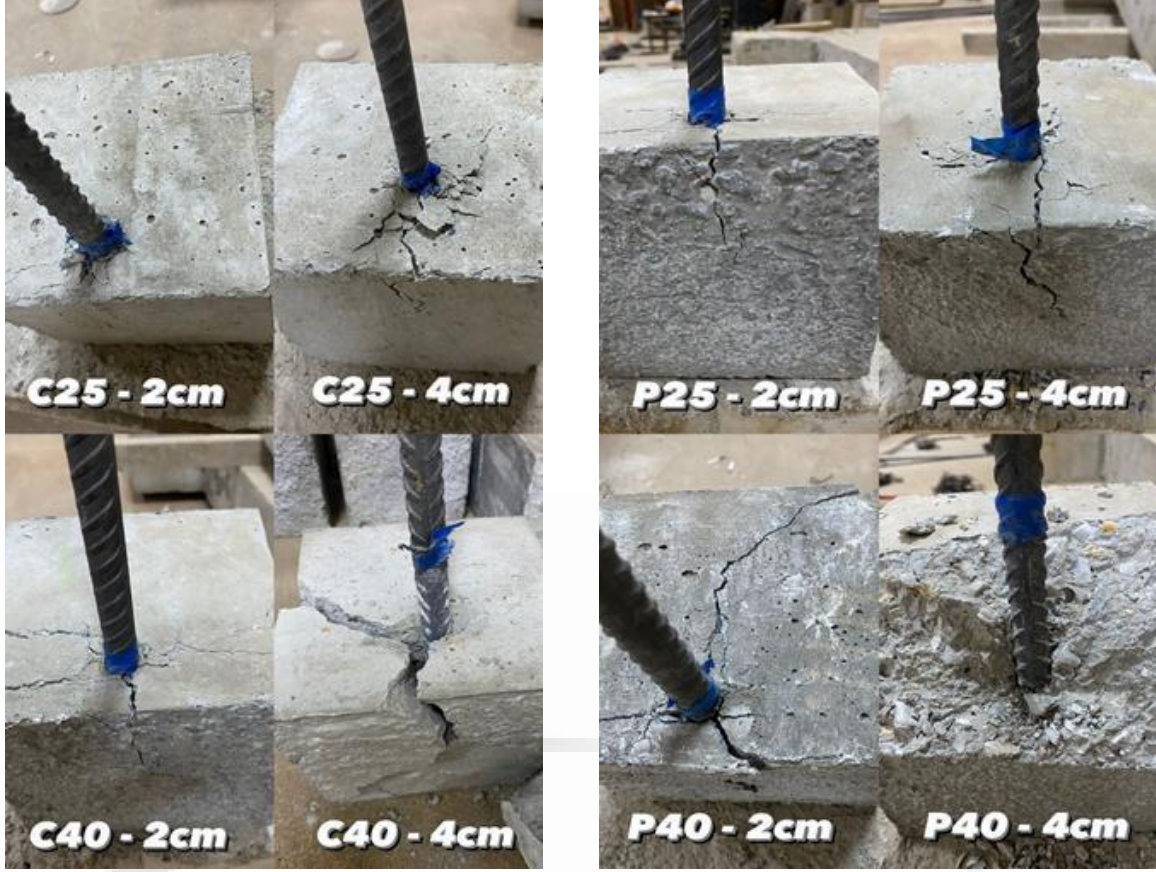
Şekil 8 numunelerin gözlemlenen hasar seviyeleri
