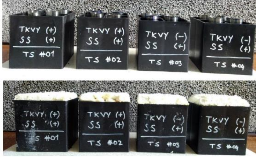
Şekil 3.10. Çelik sac ve poliüretan köpük ilaveli kutular
