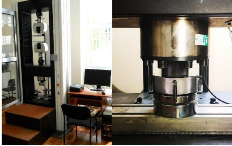
Şekil 3.12. Basma testlerinin yapıldığı üniversal test cihazı ve basma plakaları
