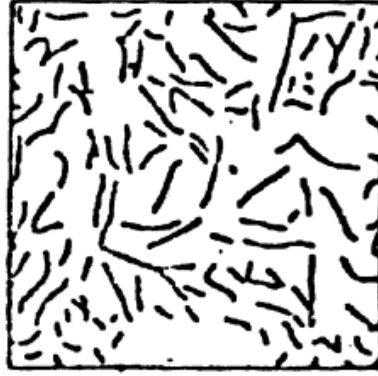
Görsel 2. ASTM standartlarına uygun olarak şematize edilen A tipi grafit yapısı [4].
