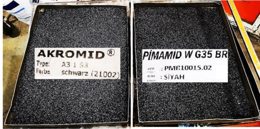
Şekil 3.1. Deneyde kullanılan hammaddeler a) Polyamid 66 (PA66) b) %35 cam elyaf takviyeli polyamid 66 (PA66-GF35)
