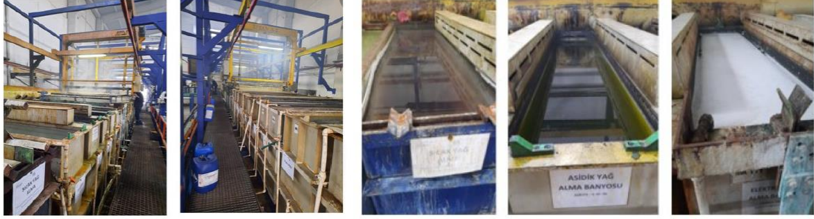
Şekil 3.1. Numunelerin kaplandığı askı kaplama hattı
