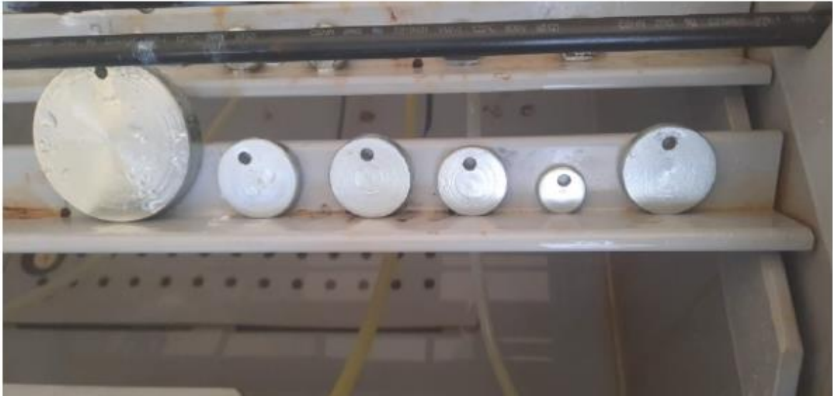
Şekil 3.7. Numunelerin tuz testi yerleşimi
