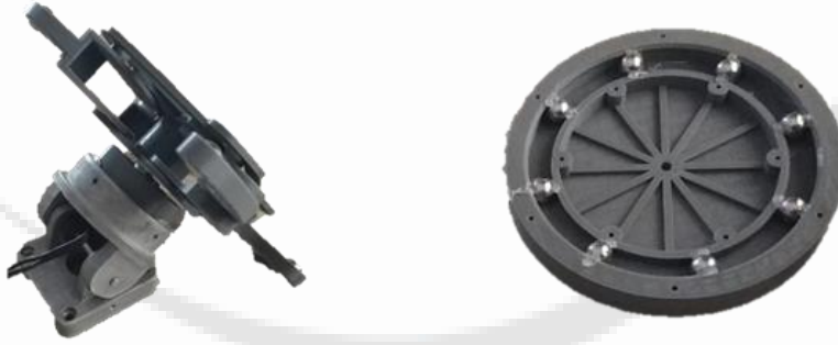
Şekil 8: Demir Bilyelerin Eklendiği 3B Yazıcıdan Basılan Rotorlar
