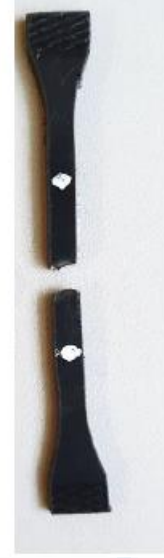
Şekil 4.1. PA ve PA-GF35 için elde edilen mühendislik gerilme-birim şekil değiştirme eğrileri ve PA için kırılmış örnek bir numune
