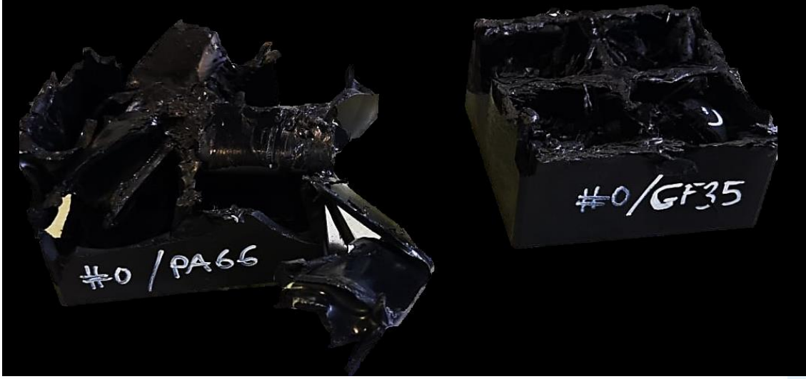
Şekil 4.4. Düşürme testi sonrası numunelerin son görüntüsü
